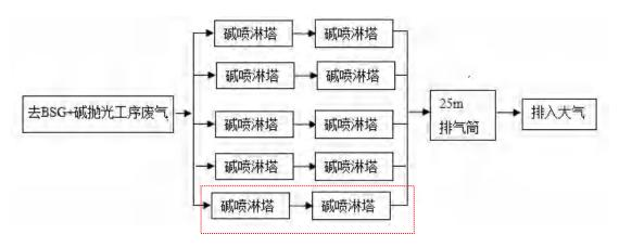
图 4.1-4 去 PSG-RCA 工序废气处理工艺流程图(红框内为备用设施)
