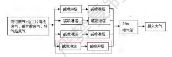
图 4.1-5 制绒废气+返工片清洗废气、硼扩散废气、特气站尾气处理工艺流程图(红框内为备用设施)
