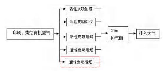
图 4.1-9 印刷、烧结有机废气处理工艺流程图(红框内为备用设施)
