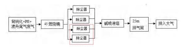
图 4.1-7 背钝化+PE+渡舟尾气废气处理工艺流程图(红框内为备用设施)
