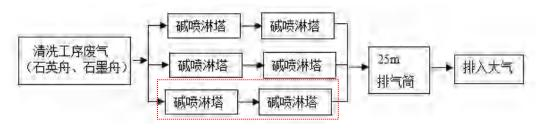
图 4.1-6 清洗工序废气 (石英舟、石墨舟) 处理工艺流程图 (红框内为备用设施)
