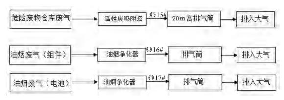
图 7.1-2 有组织废气监测点位图
