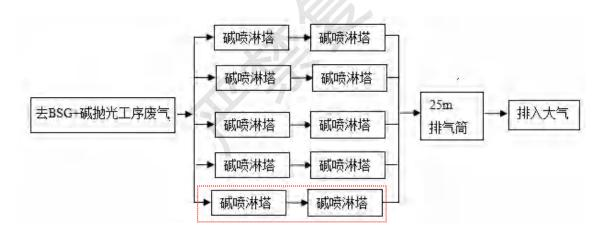
图 4.1-8 去 BSG+碱抛光工序废气处理工艺流程图 (红框内为备用设施)
